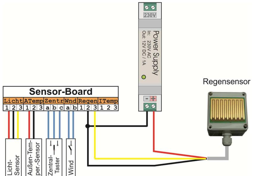
Der Sensor ist beheizt, wobei sich die Heizung nach Abtrocknung der Sensoroberfläche automatisch ausschaltet. Weitere Informationen entnehmen Sie bitte dem Datenblatt, welches wir unter [http://heytech.net/regensensor\\_datenblatt.pdf](http://heytech.net/regensensor_datenblatt.pdf) bereitstellen.
